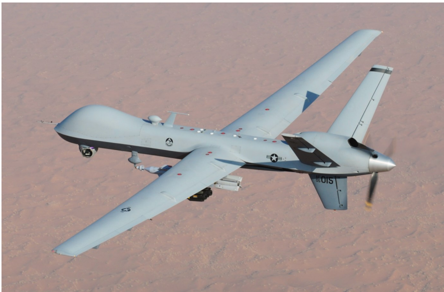
El MQ-9 Reaper es uno de los drones de ataque más emblemáticos y utilizados por las fuerzas armadas occidentales. Su imagen en vuelo, con misiles Hellfire visibles en las alas, implica la realidad frente al uso de drones militares con capacidad letal en conflictos armados internacionales. Foto: LtCol. Leslie Pratt (Wikipedia)
