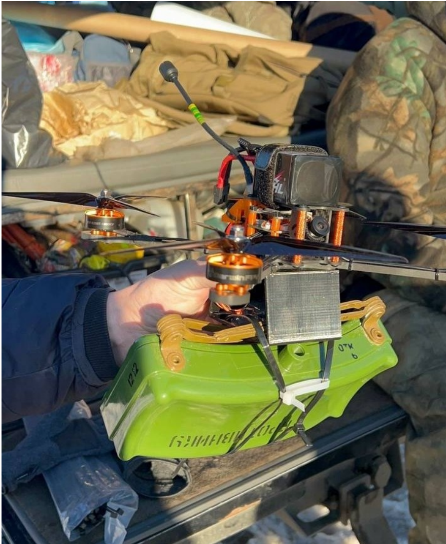
Dron de fabricación rusa modificado artesanalmente para portar una mina antipersonal de tipo Claymore, modelo MON-50. Foto: https://vk.com/milinfohive?w=wall-123538639_3524133 .
